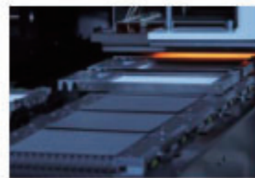
图五，Schmid Multi-Busbar Connector串焊机
